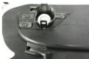
Werkstückaufnahmen umfassen 3D-Profilen zum Schutz der genarbteten Aussenfläche „A“ und gewährleisten zudem während des gesamten Schweissprozesses die genaue und konzentrische Anordnung der Blende in der Kühlergrillöffnung. Bei dieser Anwendung lädt der Bediener die Werkstücke auf einen verriegelten Schiebetisch, der den Schweisszyklus auslöst, wenn er sich in der geschlossenen Position befindet.
