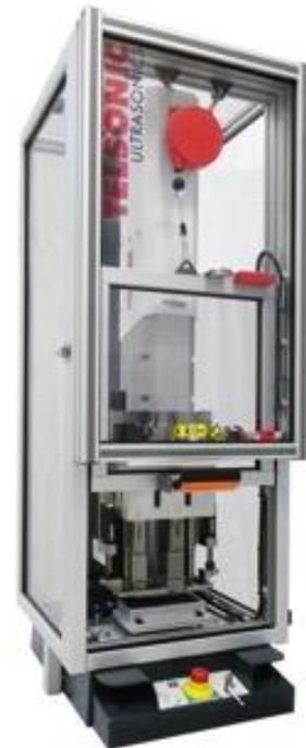
**(Die Gehäuseblenden für die Fensterbetätigungen werden für den Jaguar X760 mit Ultraschallschweisspressen der Serie USP2000 von Telsonic produziert)**
