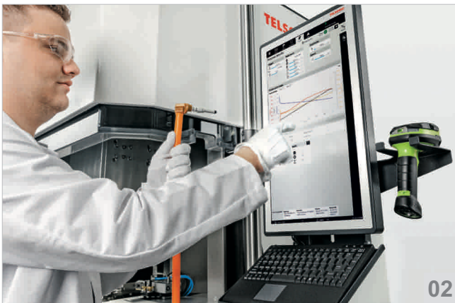
02 조작 소프트웨어 Telso®Flex는 조작자와 기계 사이에서 완벽한 상호작용을 가능하게 하며 용착 공정에 대한 피드백을 지속적으로 제공합니다. 이런 방식으로 포괄적 공정 모니터링을 통해 높은 수준의 품질 요건을 만족시킬 수 있습니다. (저작권자: Telsonic)
