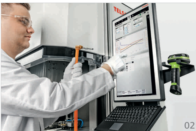
02 Il software operativo Telso®Flex consente un'interazione perfetta tra operatore e macchina e fornisce un feedback costante sul processo di saldatura. Ciò consente di soddisfare gli elevati requisiti di qualità attraverso un completo monitoraggio del processo. (Autore: Telsonic)
