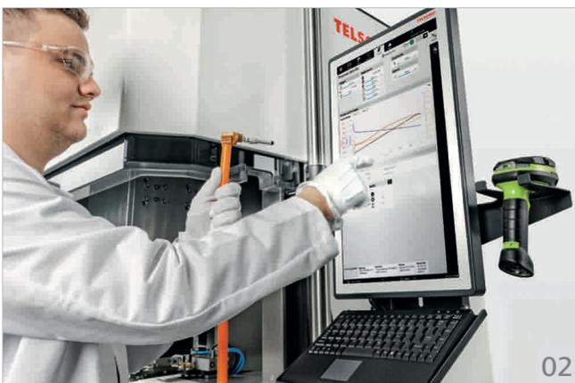
**02** Die Bediensoftware Telso®Flex ermöglicht die perfekte Interaktion zwischen Bediener und Maschine und gibt stets Feedback zum Schweißprozess. So lassen sich die hohen Qualitätsansprüche mittels umfangreicher Prozessüberwachung erfüllen. (Urheber: Telsonic)
