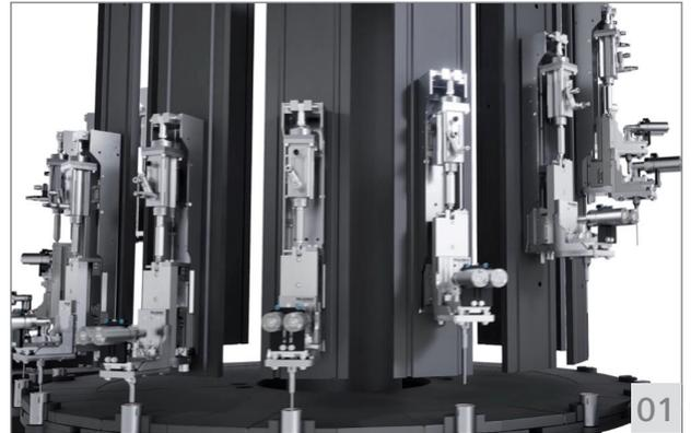
01 La tecnología de ultrasonidos puede integrarse fácilmente en los sistemas de automatización de alta velocidad empleados en la producción de celdas de batería cilíndricas de baterías de iones de litio para vehículos eléctricos
