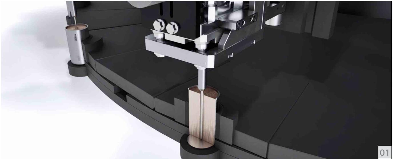
01 Ultraschallschweiss-Systeme von Telsonic in der Batteriezellenfertigung (Pol-Schweissung)
