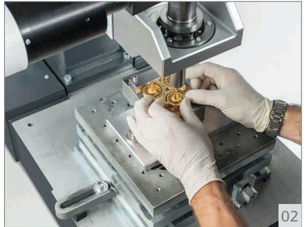
02 텔소닉이 개발하여 특허를 받은 토셔널 용접 공정은 용접 대상물에 유입되는 원치 않는 진동을 크게 줄여 줍니다.
