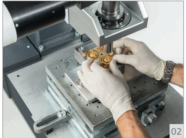
02 Il processo di saldatura torsionale sviluppato e brevettato da TELSONIC riduce notevolmente l'ingresso di vibrazioni indesiderate nell'oggetto saldato.
