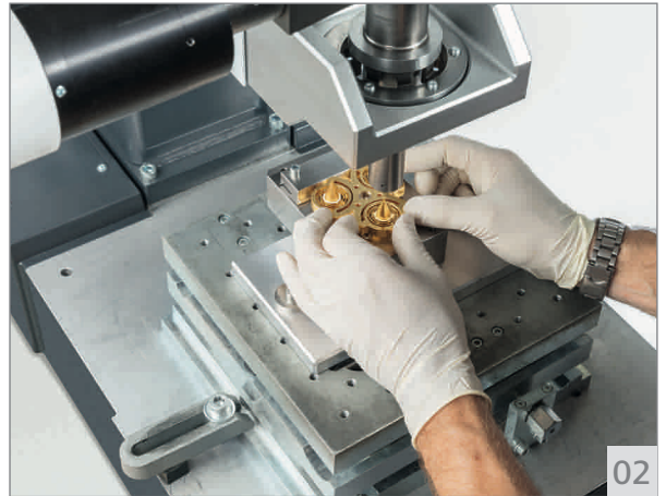
02 El proceso de soldadura torsional desarrollado y patentado por TELSONIC reduce en gran medida la entrada de vibraciones no deseadas en el objeto soldado.
