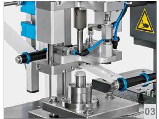
03 3-헤드 초음파 캘린더링 기계 Telsonic SoniqTwist® 시스템은 미니 필터 멤브레인을 위한 한 번의 인라인 이동으로 절단 및 용착 공정을 결합합니다.
