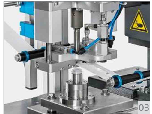
03 Calandratura a ultrasuoni a 3 testine Il sistema SoniqTwist® di Telsonic combina i processi di taglio e saldatura in un unico movimento in linea per le mini membrane filtranti.
