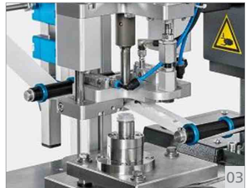
03 Calandradora de ultrasonidos de 3 cabezales Sistema SoniqTwist® de Telsonic que combina los procesos de corte y soldadura en un solo movimiento en línea para mini membranas de filtro.
