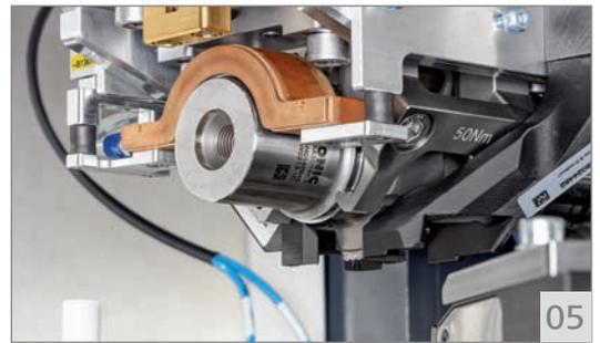
05 El sonotrodo y los colectores se mantienen dentro del rango de temperatura requerido mediante el circuito de refrigeración por líquido
