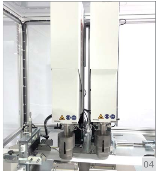
04 I sonotrodi e le incudini doppi e sfalsati massimizzano la produttività ottimizzando l'uso del materiale
