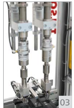
02/03 공냉식 정밀 조절형 스프링 통합 컨버터 모듈과 Telsonic AC450 공압 액추에이터에 장착된 티타늄 부스터
