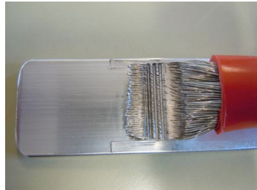
Bild Nr. 31-04 TC_PW-AlKnoten2.jpg. Weltweit einzigartig: Eine Schweißung von 120 mm 2 Aluminiumleitung ist beispielsweise nur 22 mm breit.
