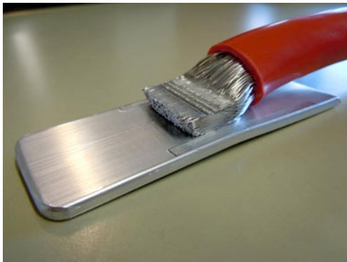
Bild Nr. 31-03 TC_PW-AlKnoten.jpg. Beim Verschweißen von Litzen sind bis zu 30 % schmalere und höhere Knoten möglich.
