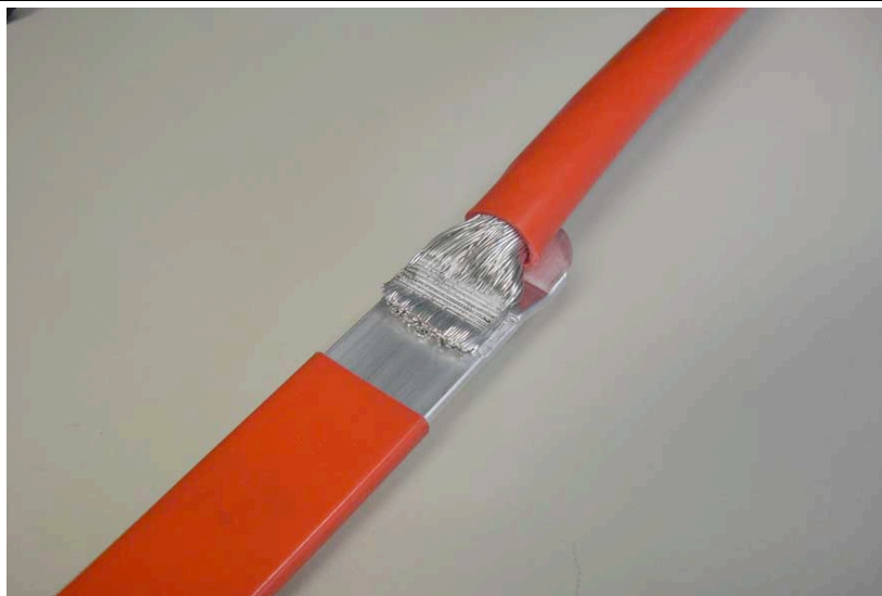
Bild Nr. 14-01 TC_AK-Kontakt1.jpg Der Übergang von starrer Aluminium-Flachleitung zu flexibler Aluminium-Rundleitung ist mit Ultraschall-Schweißtechnik von Telsonic als reine intermetallische Verbindung realisiert.
