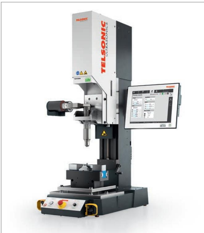
Die Applikation wurde mit der torsionalen SONIQTWIST® Technologie geschweisst. Oben die torsionale Schweißanlage TSP3000.
