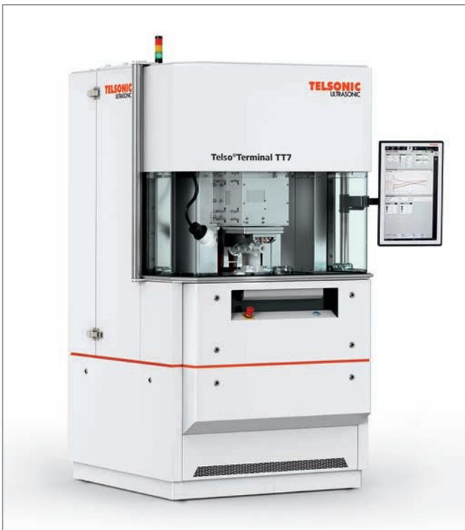
Die Applikation wurde mit der torsionalen PowerWheel® Technologie geschweisst. Die Ultraschallschweisskomponenten der Telso® Terminal TT7 wurden in einer Sonderanlage integriert. Oben die Telso® Terminal TT7 mit einer maximalen Schweißleistung von 14.4kW.
