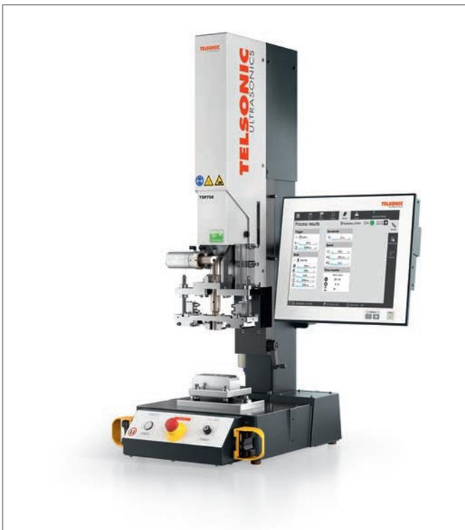
Die Applikation wurde mit der torsionalen SONIQTWIST® Technologie geschweisst. Die Ultraschallschweisskomponenten wurden in einer Sonderanlage integriert.
