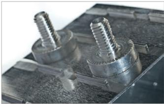
Die Applikation wurde mit der torsionalen SONIQTWIST® Technologie geschweisst. Oben die torsionale Schweissanlage TSP3000.
