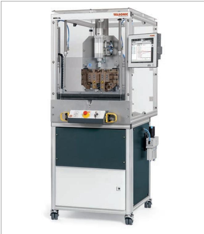
Die Applikation wurde auf der Ultraschallschweissanlage MPX-GL mit automatischer Isolationscrimpung realisiert.
