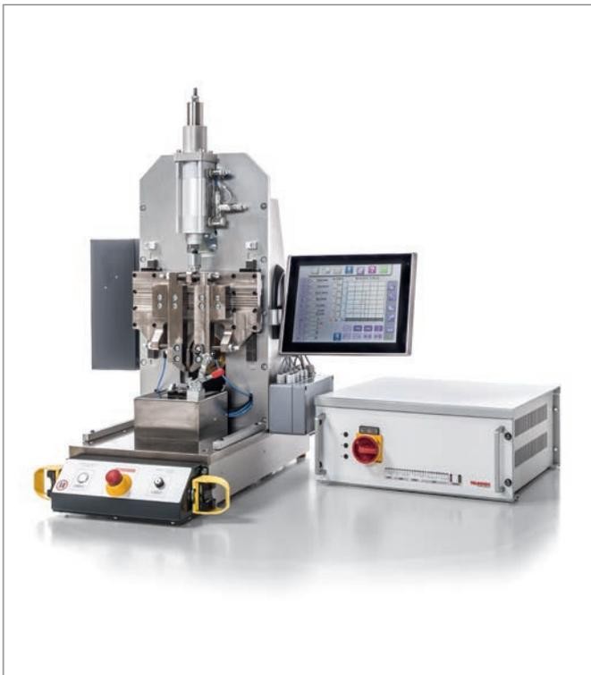
Die Applikation wurde auf einer linearen Ultraschallschweissanlage des Typs MPX, Leistung 3,6 kW, mit entsprechender Spezialvorrichtung realisiert.
