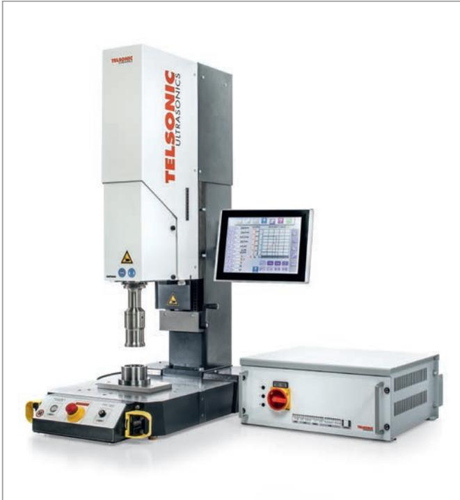
L'applicazione è stata creata su un impianto di saldatura a 20 kHz del tipo USP3000 con generatore MAG da 3600W e comando di processo TCS5 con touchscreen.
