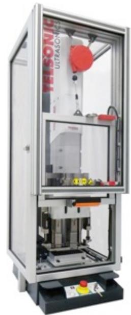
**(捷豹 X760 窗口控制器外壳玻璃框采用 Telsonic USP2000 超声波压焊机生产而成)**
