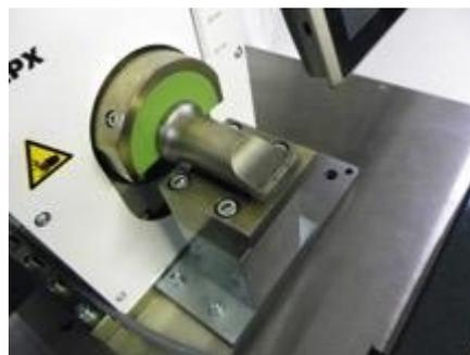
（两种不同的工具面配置（单一和三重工具面）支持在项目过程中进行焊接比较与评估）
