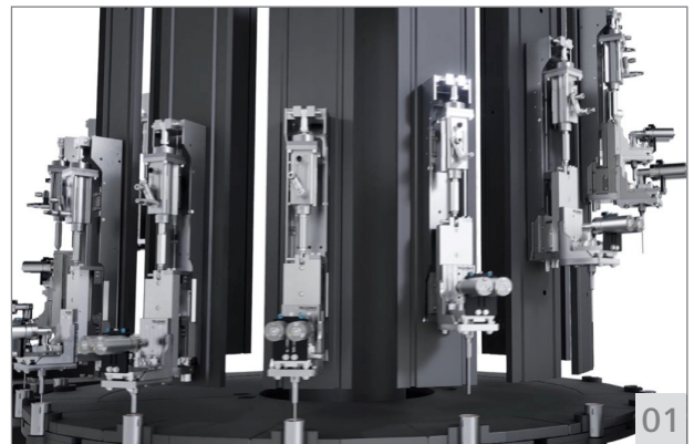
01 超声波技术可以轻松集成到用于生产电动汽车的圆柱形锂离子电池单元的高速自动化系统中
