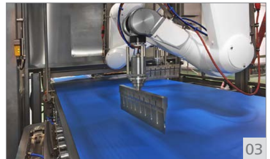
01 Telsonic 新款 760mm 刀片进一步提高了盘烤制品机器 02 人上的超声系统的效率和生产率 03
