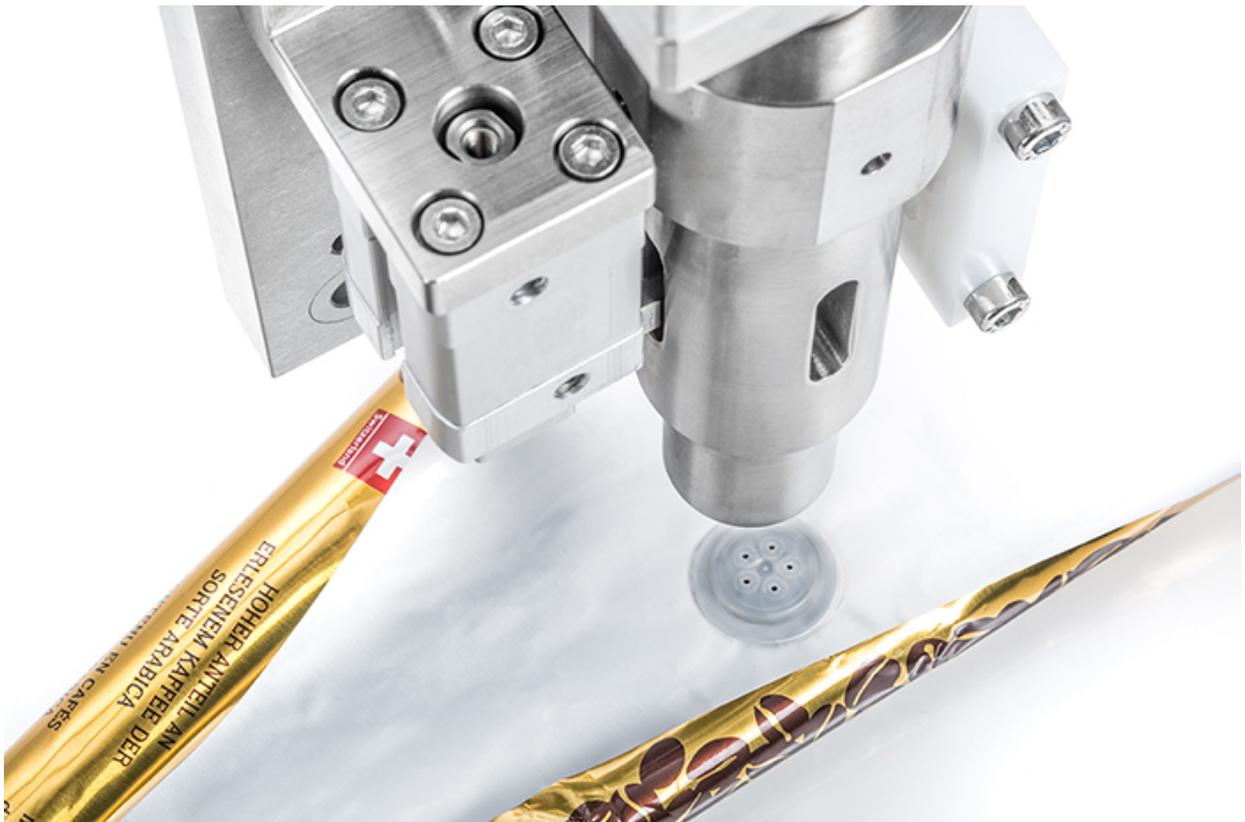
设备可以在灵活的咖啡包装薄膜上焊接排气阀
