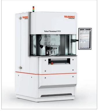
该应用采用扭转式 PowerWheel®技术焊接而成。 Telso®Terminal TT7 的超声波焊接组件已集成在特殊设备中。 上面为最大焊接功率为 14.4kW 的 Telso®Terminal TT7。
