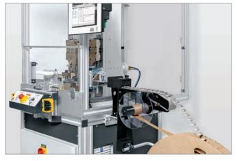
应用通过带有自动进给装置的 MPX-RT 超声波焊接设备实现。
