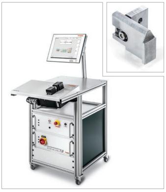
这些应用通过带终端止挡的绞线焊接设备 Telso®Splice TS3 实现。
